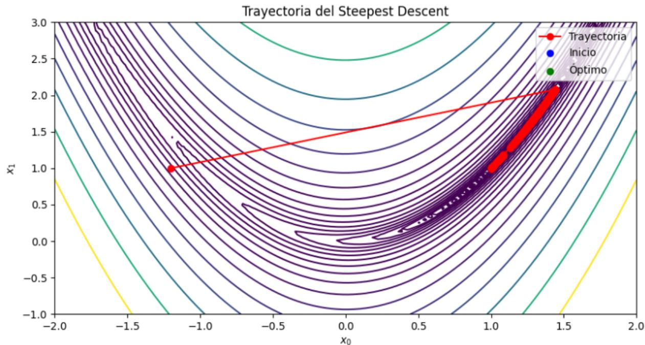
Figure: Trayectoria Steepest Descent con Golden Ratio
